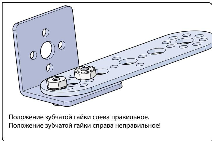
Положение зубчатой гайки слева правильное.
