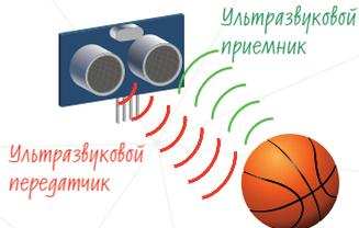
«Ультразвуковой» означает «выше уровня звука». Человек может слышать звуки в диапазоне от 20 до 20 000 Гц. Ультразвуковые волны имеют частоту более 20 000 Гц. Когда эти звуковые волны сталкиваются с препятствием и возвращаются, приемники датчика определяют расстояние до препятствия.
