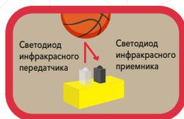
Светодиод инфракрасного передатчика излучает инфракрасный свет, а приемник принимает инфракрасный свет, отражающийся от объекта. Расстояние между датчиком и объектом рассчитывается на основе угла падения света на приемник.
