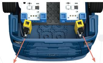
1 Подключите датчики приближения к входам D4/A6 и D12/A11 программного модуля. Измените их направление, как показано на рисунке, и подключите к входам 2 x 1 под тонким блоком основания. **Убедитесь, что бесконтактные датчики установлены в режим «а».**
