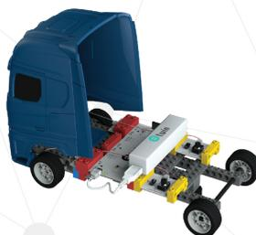
3 Подключите контакты выходов, расположенных вверху ультразвукового датчика, к аналогичным входам программного модуля с помощью соединительных кабелей штекер-разъем (VCC, Trig, Echo, GND).
