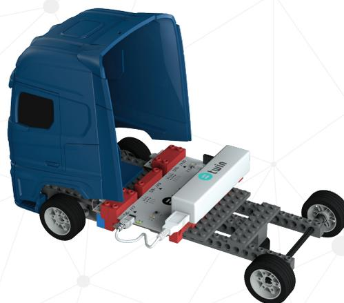
Подключите внешний аккумулятор к программному модулю, как показано на рисунке, и установите поверх модулей. **Убедитесь, что двигатели постоянного тока находятся в режиме «Программирование».**
