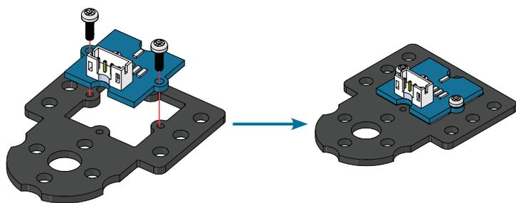
Винты в этом комплекте имеют самонарезающую резьбу, благодаря которой они закрепляются в гнездах пластмассовой установочной пластины. Для их установки можно использовать отвертку 4-в-1, которая входит в робототехнический набор TETRIX. Следите за тем, чтобы не перетянуть винты при затяжке, так как это может привести к повреждению пластмассовой установочной пластины.
