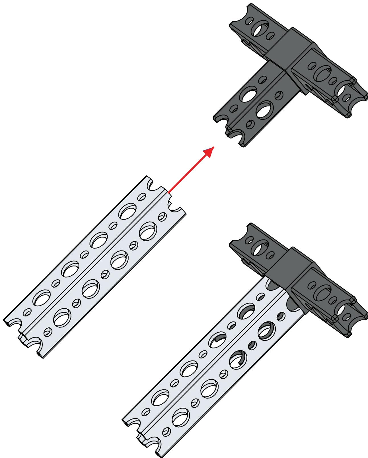
Для быстрого закрепления соединителей можно использовать втулки и штифты быстросменных заклепок. С нажимом вставьте втулку заклепки в нужное место на балке и с помощью штифта раздвиньте заклепку в отверстие, чтобы закрепить место соединения. Установка быстросменных заклепок с обеих сторон позволит повысить прочность соединения.
