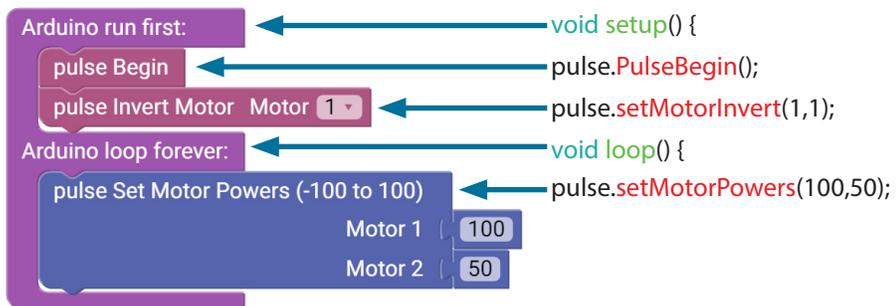
**Примечание:** Мощность вращения электродвигателя 1 в два раза больше мощности вращения электродвигателя 2.
