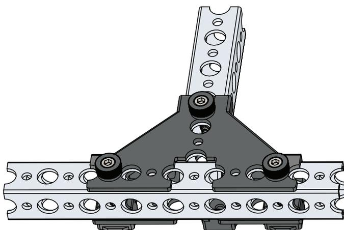
Торцевые балочные соединители, блочные соединители для параллельного крепления, а также блочные соединители для крестообразного крепления под углом 90 градусов закрепляют при помощи винта с рифлёной головкой, который необходимо пропустить через балку и ввернуть в соединитель.
