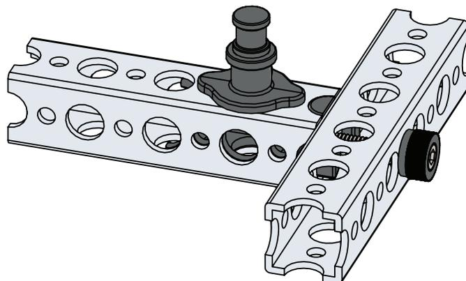
При использовании ось всегда должна иметь две точки опоры. Установите по бронзовой втулке на противоположных сторонах балки и пропустите ось через втулки. Закрепите ось на установочном кольце вала с лыской, колесе, шестерне или ступице.
