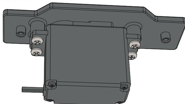
**ВАЖНО:** Перед установкой на стандартный сервопривод правого зубчатого рычага необходимо прикрепить стандартный сервопривод к пластине захватного устройства. Далее подключите стандартный сервопривод и приведите его в нейтральное положение, чтобы расположить зубчатые секторы, как показано на иллюстрациях к следующим шагам. Указания по установке деталей конструктора TETRIX PRIME также представлены по адресу [TETRIXrobotics.com](http://TETRIXrobotics.com).
