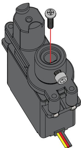
Совместите шлицы на ступице со шлицами на валу сервопривода и нажатием соедините детали. Установочный винт должен максимально точно совпасть с центральной осью корпуса сервопривода. Занятие винт, удерживая ступицу в правильном положении.
