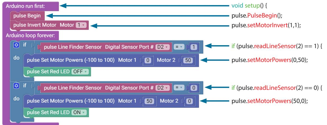
**Примечание:** Одно колесо будет вращаться, второе — тормозить, в зависимости от показаний датчика линии.
