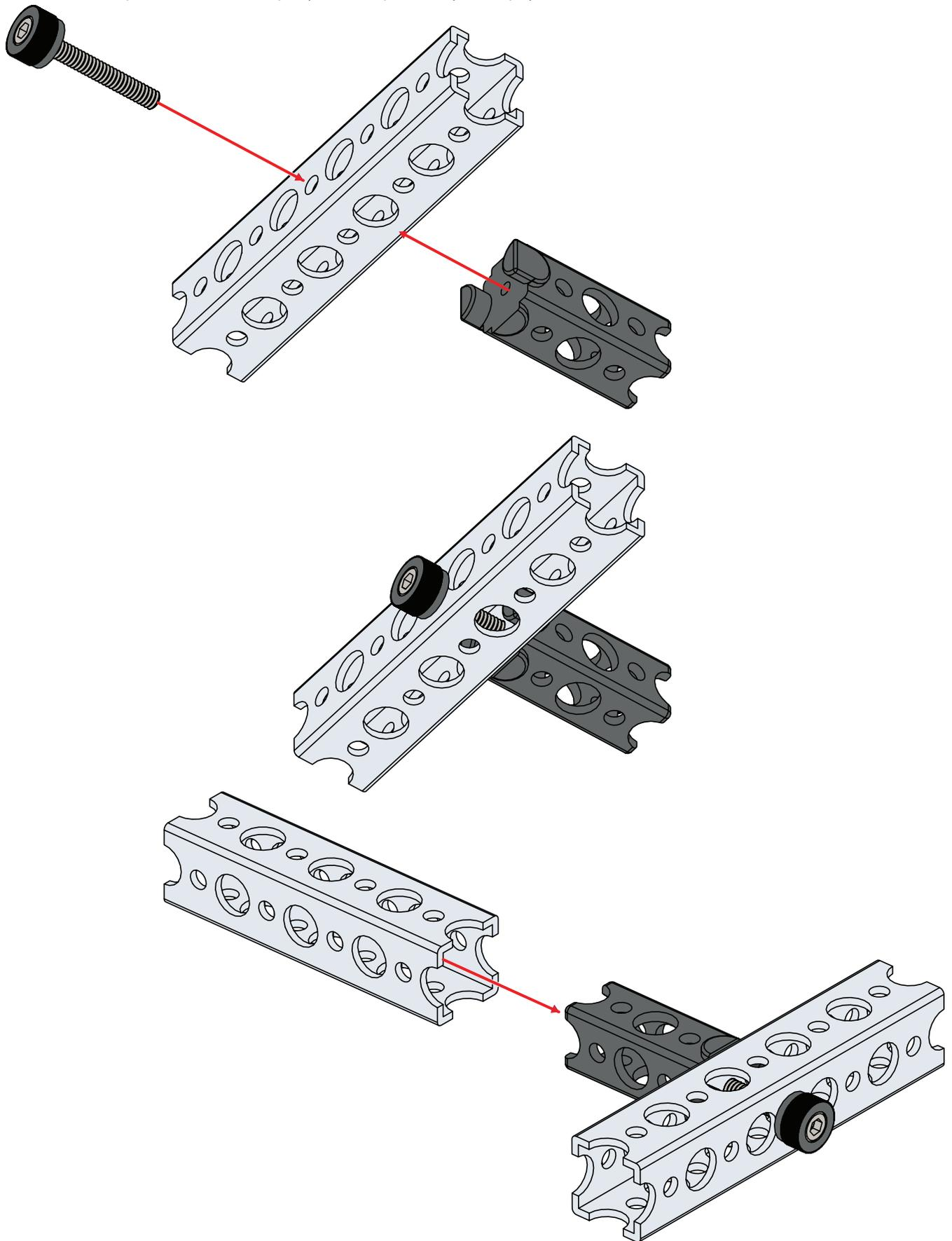
Закрепив торец соединителя винтом с рифлёной головкой, поперечную балку крепят быстросменной заклепкой со штифтом, либо винтом с рифлёной головкой и барашковой гайкой.
