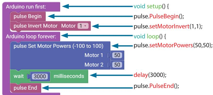
**Примечание:** Запрограммируйте два электродвигателя на вращение в противоположных направлениях с помощью блока pulse Invert Motor.
