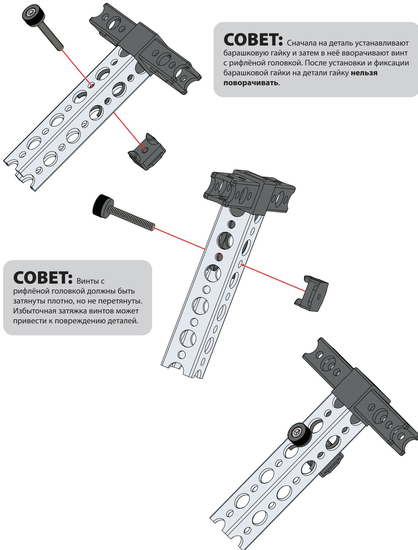
Для соединения балок можно использовать и скобы. Имеющиеся скобы позволяют соединять детали Т-образно, под углом 60 градусов или под углом 90 градусов. Скобы следует использовать попарно, устанавливая по две скобы на противоположных сторонах балки. Скобы крепятся при помощи быстросменных заклепок со штифтами, либо при помощи винтов с рифлёной головкой и барашковых гаек.
