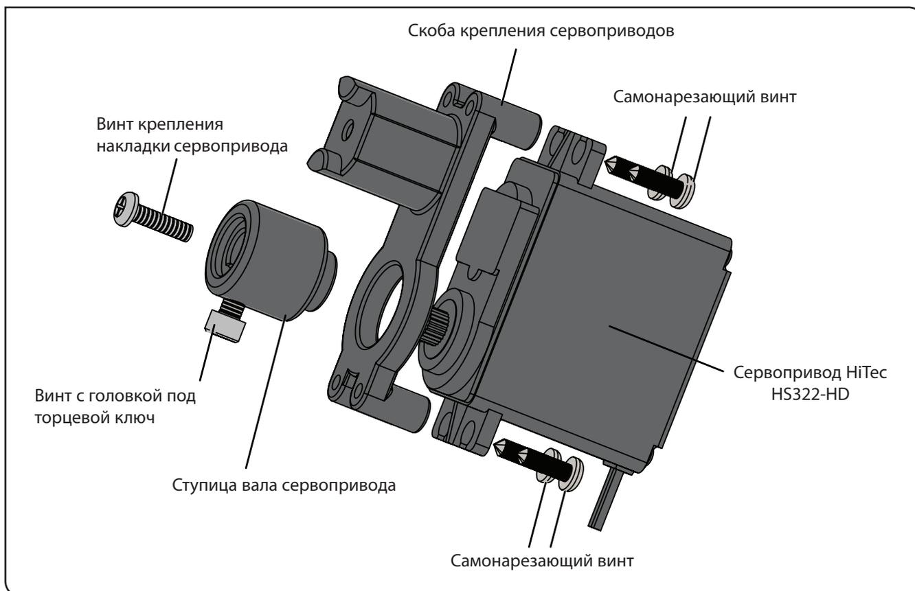
**СОВЕТ:** Сервопривод продолжительного вращения устанавливается на скобе крепления сервопривода таким же образом, как и стандартный сервопривод, однако без необходимости центрировать накладку сервопривода.
